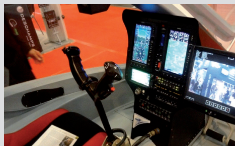
Widok wnętrza kabiny samolotu OSA z pracującym systemem SSWDiR.
