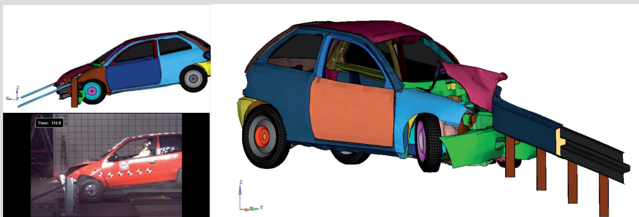
Porównanie deformacji obiektu rzeczywistego i modelu komputerowego pojazdu uderzającego we fragment drogowej bariery ochronnej
