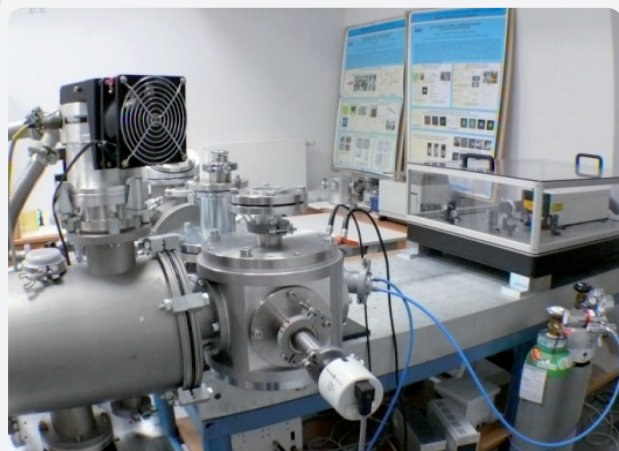
Mikroskop EUV pracujący na dł. fali \lambda = 13,8 nm
