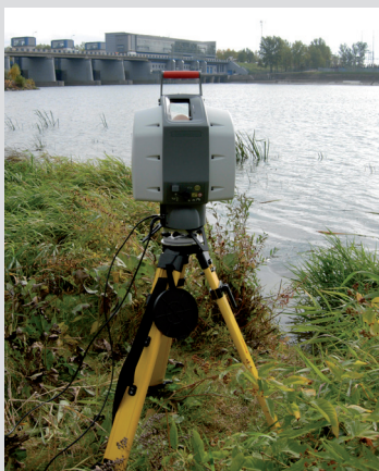
Skanowanie zapory wodnej
