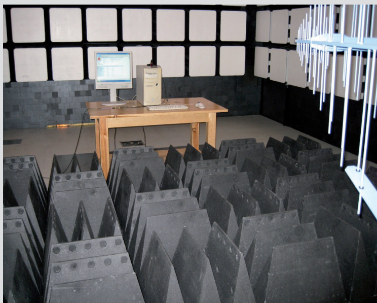
Widok stanowiska pomiarowego w komorze bezodbiciowej
