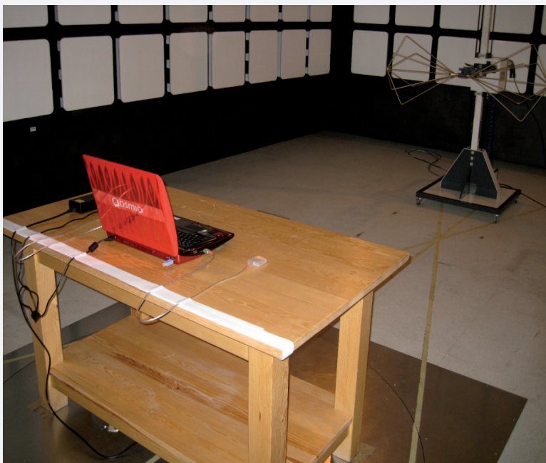
Widok stanowiska pomiarowego w komorze bezodbiciowej
