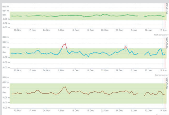
Zmiany współrzędnych jednej z monitorowanych stacji referencyjnych
