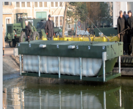
Opuszczanie pływaka wypełnionego powietrzem do wody
