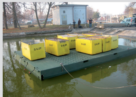
Próba wyporności i stabilności
