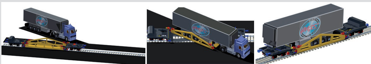
Schemat załadunku i rozładunku wagonu z platformą obrotową
