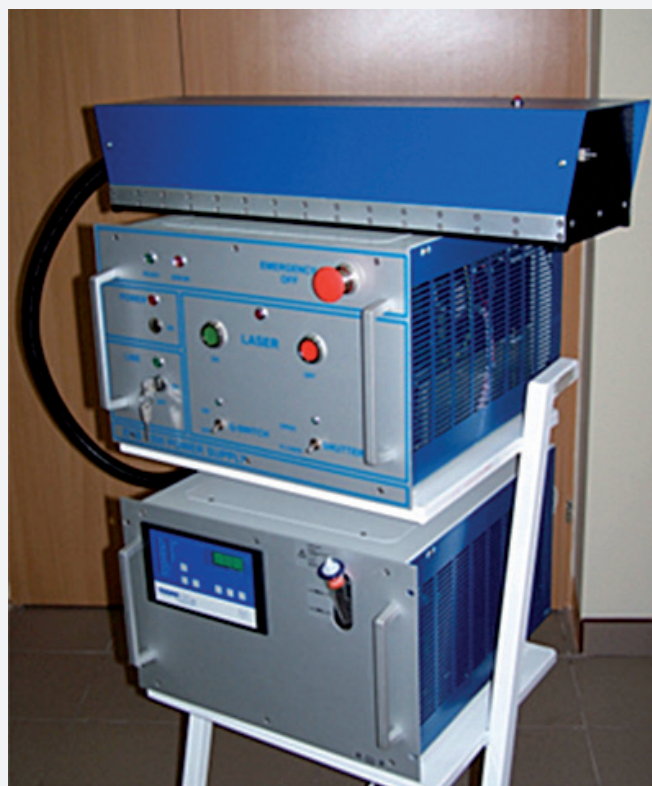
Zdjęcia części optycznej lasera (z lewej) i całego urządzenia z układem zasilania, sterowania i chłodzenia (z prawej)
