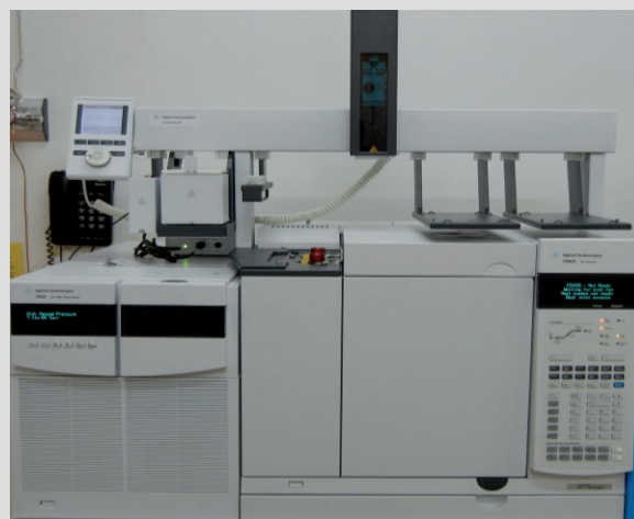
Chromatograf gazowy z tandemowym detektorem mas (GC-MS/MS), wyposażony w automat dozujący próbki przygotowane metodą SPME
