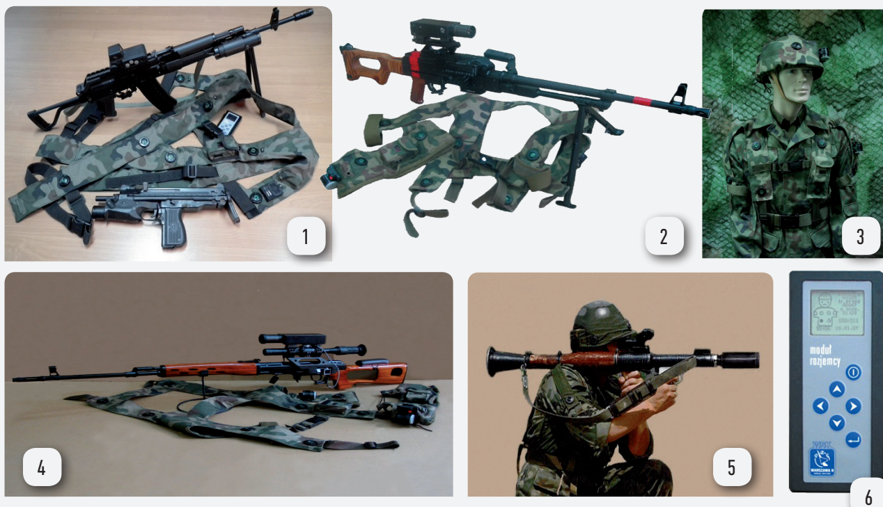
Symulatory laserowe dla pojedynczego żołnierza: 1. beryl, 2. SWD, 3. PK, 4. RPG-7, 5. zestaw detektorów na szelki i hełm, 6. pilot rozjemcy
