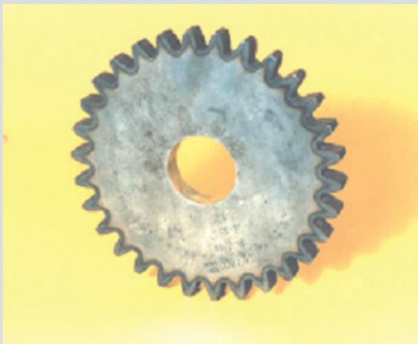
Laserowe hartowanie elementów maszyn - koto zębate
