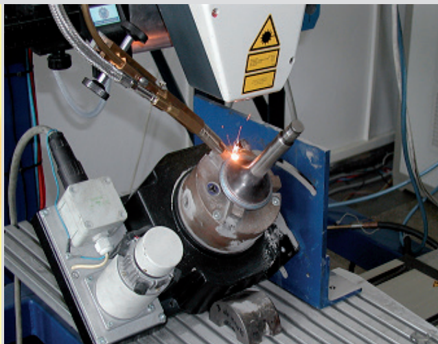
Laserowe napawanie przyłgni zaworów silników spalinowych
