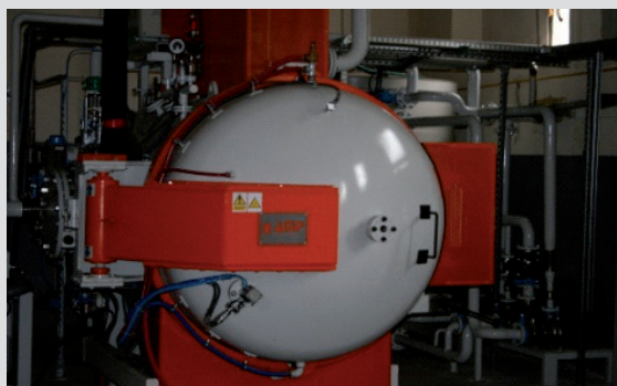
Nowy próżniowy piec do kompleksowej obróbki cieplnej chłodzony ciekłym azotem [fot. A. Dębski]
