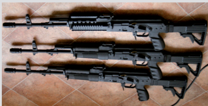
Karabinki wz. 1966 Beryl z lufami wykonanymi według nowej technologii [fot. A. Dębski]
