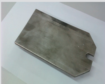
Łopátka wentylatora z naniesioną techniką LENS powłoką ochronną na osnowie fazy Fe 3 Al
