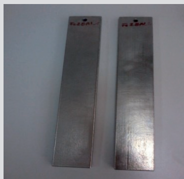
Elementy z powłoką ochronną FeAl przeznaczone do pracy w płynnej biomasie
