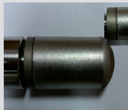
Ośłona termopary do kotła fluidalnego spalającego biomasę – powłoka Fe 3 Al
