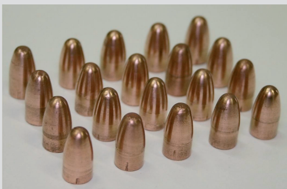
Pociski fragmentujące z kompozytu Cu-Sn
