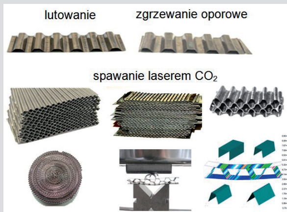
Przykładowe struktury typu „plaster miodu” wykonane z taśm Ni 3 Al
