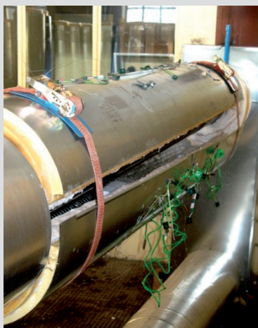
Składanie dwóch części okładziny na stanowisku badawczym
