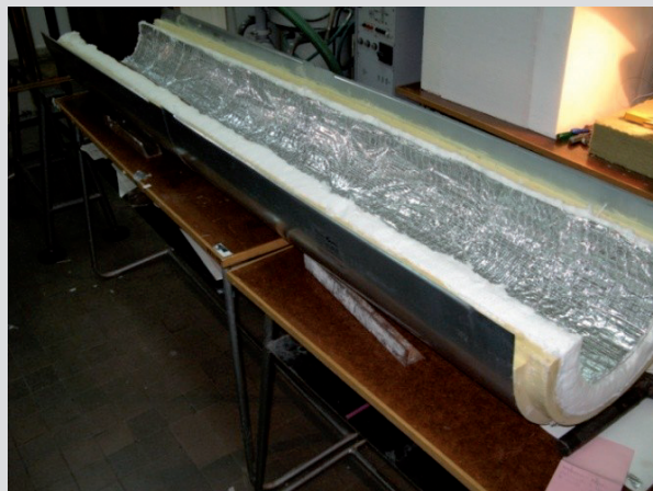
Jedna z dwóch części okładziny wielowarstwowej izolacji termicznej ciepłociągów pary wodnej
