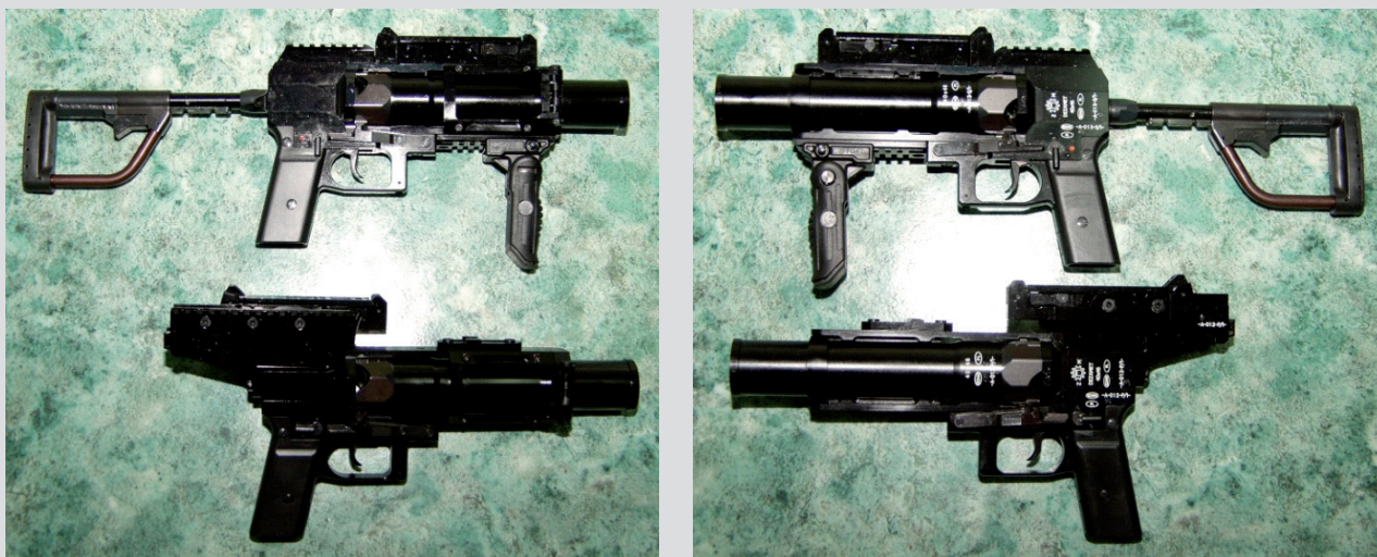
Granatniki systemu SBAO-40 (widok z prawej i lewej strony, od góry): samodzielny GSBP-40 i podwieszony GPBO-40 [fot. J. Kijewski]
