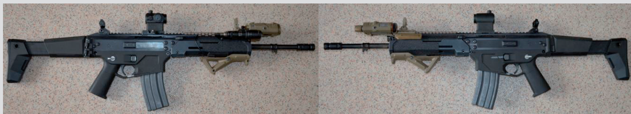
5,56 mm karabinek standardowy MSBS-5,56Kz kolbą rozłożoną i wysuniętą (strona prawa i lewa) [fot. W. Koperski]
