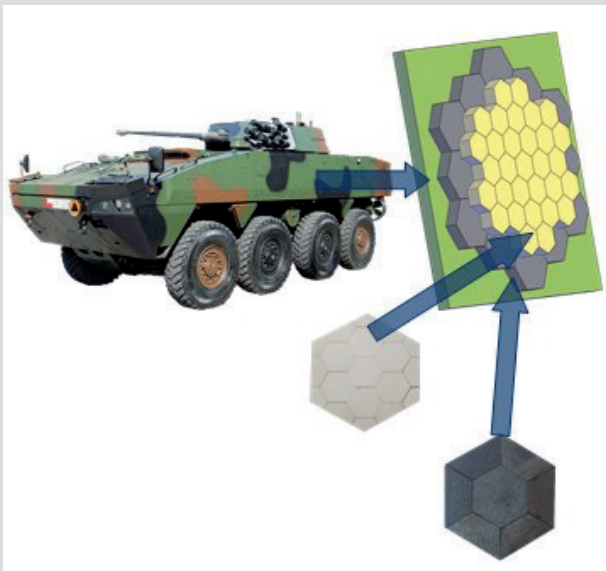
Koncepcja niejednorodnej osłony balistycznej w formie pancerza dodatkowego mocowanego na pancerzu zasadniczym bojowego transportera opancerzonego
