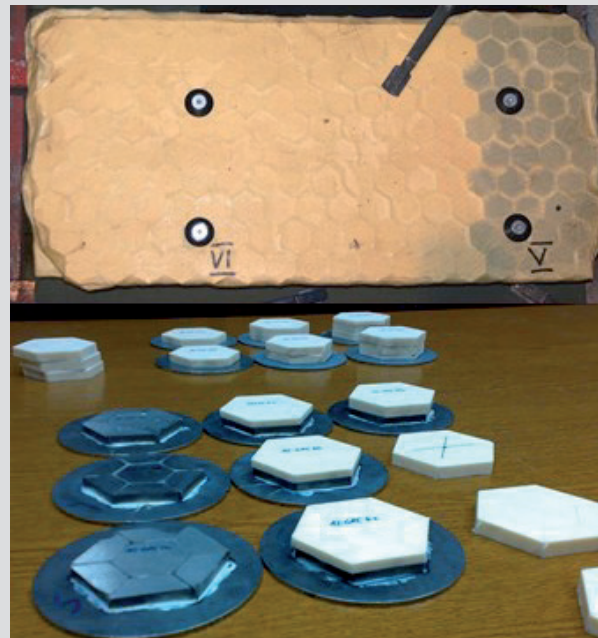
Widok osłony balistycznej przeznaczonej do testów poligonowych oraz różnych wariantów ułożenia poszczególnych warstw pancerza
