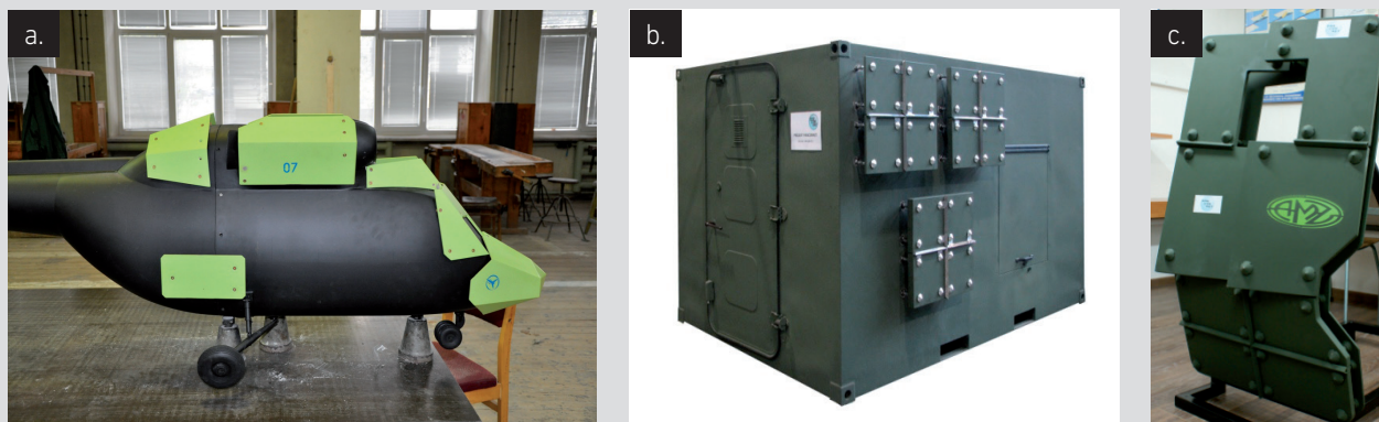
Przykładowe obiekty przewidziane do poprawy ochrony balistycznej: (a) śmigłowiec-widok modelu kadłuba „Sokół” w skali 1:6, (b) kabina-kontener, (c) drzwi lekkiego pojazdu opancerzonego
