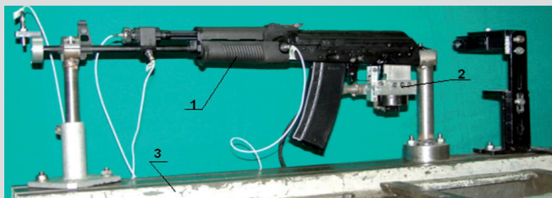
Stanowisko badawcze Typ 5,56B: 1 – obiekt badań na stanowisku, 2 – elektroszust, 3 – podstawa z uchwytami mocującymi broń [fot. J. Kijewski]
